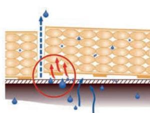
Působením mrazu na zadržovanou vlhkost na spodní straně vysoko sliňutých, nenasákových výrobků (nasákovost pod 0,5%) dochází často k přerušení spojení s lepícím tmelem a k jejich „*odskočení*“. Obdobně působí v letním období tlak vodních par v podkladní vrstvě.
