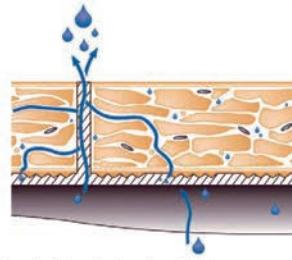
Střep tažených výrobků se vyznačuje homogenní strukturou s podélnými, vzájemně propojenými póry, kterými je vlhkost rychle nasávána i uvolňována. Tím jsou zajištěny trvalé podmínky pro dokonalé spojení s podkladem, podélné póry pak zaručují i při nasákovosti až do 6% mrazuvzdornost střepu s 25-letou zárukou.
