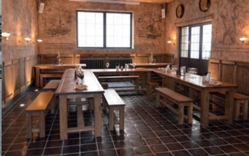
V našem sortimentu naleznete také čedičové dlažby Eutit. V podstatě se jedná o tavený čedič v různých designech a površích. Technologicky jde o dokonalý produkt, který je mrazuvzdorný a lze ho díky technickým vlastnostem použít absolutně kdekoli, tzn. i při těch nejvyšších zatíženích, jako jsou výrobní provozy, veřejné komerční plochy apod.
